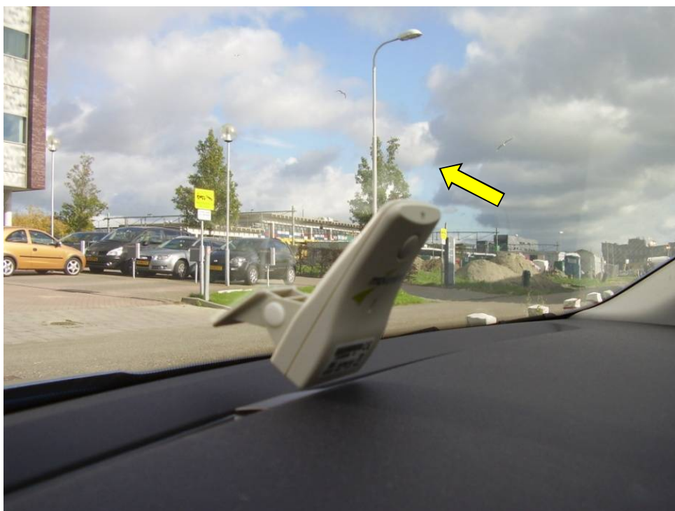
Figuur 3 Bij extreem vlakke ruit: bovenkant van de t-tag tegen de ruit aan drukken
